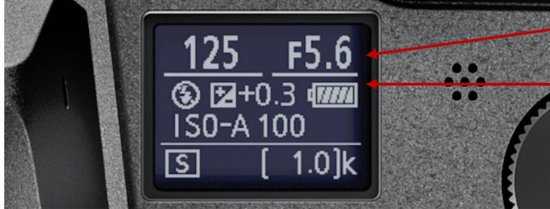
**1 – réglages appareil photo : Mode M (manuel) - Iso : sensibilité nominale de capteur - Vitesse : Synchro-flash de mon appareil**
